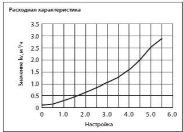
Диаграмма для подбора настройки клапана типа MSV-BD DN = 15 мм
