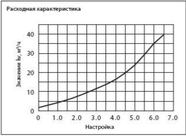
Диаграмма для подбора настройки клапана типа MSV-BD DN = 50 мм
