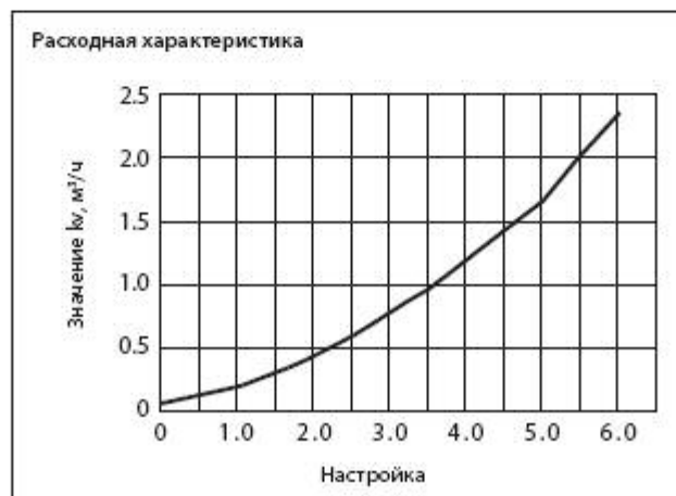
Диаграмма для подбора настройки клапана типа MSV-BD DN = 15 мм LF версия
