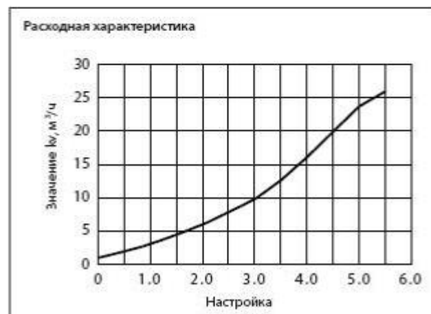
Диаграмма для подбора настройки клапана типа MSV-BD DN = 40 мм
